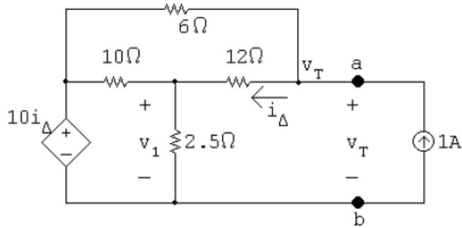
$$\frac{v_1 - 10i_\Delta}{10} + \frac{v_1}{2.5} + \frac{v_1 - v_T}{12} = 0$$
